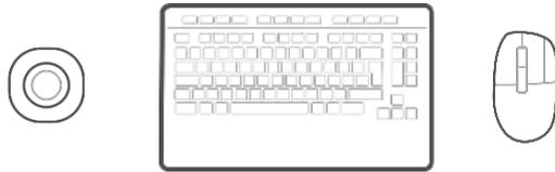
SpaceMouse Wirelessを標準マウスとキーボードの反対側に置きます。片方の手で3Dマウスを操作し、モデルを回転、パン、ズームします。もう片方の手は標準のマウスを使って、選択、作成、編集を行います。
