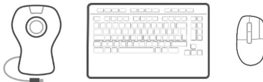
Расположите мышь SpaceMouse Pro со стороны клавиатуры, противоположной стороне, на которой вы размещаете обычную мышь. Одной рукой управляйте 3D мышью для изменения положения модели (вращение, панорамирование и масштабирование). Другой рукой управляйте обычной мышью (выбор, создание и редактирование модели).
