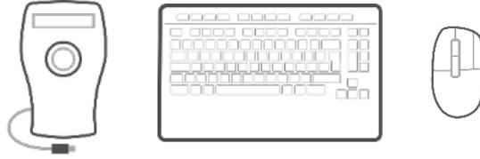
SpaceMouse Enterprise 를 표준 마우스의 키보드 반대편에 놓으십시오. 한 손은 3D 마우스를 조작하여 회전, 수평이동, 확대/축소 등 모델의 위치를 조정합니다. 반대 손으로는 표준 마우스를 조작하여 선택, 생성, 편집합니다.
