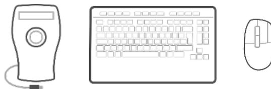
Posizionare lo SpaceMouse Enterprise sul lato della tastiera opposto al lato di utilizzo del mouse standard. Con una mano si utilizzerà il mouse 3D per ruotare e traslare il proprio modello, mentre con l'altra si utilizzerà il mouse standard per eseguire comandi di selezione, creazione e modifica.
