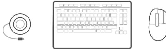
Platzieren Sie die SpaceMouse Compact auf der gegenüberliegenden Seite der Tastatur zu Ihrer Standardmaus. Mit einer Hand bedienen Sie die 3D-Maus, um Ihr Modell zu positionieren: Drehen, Schwenken und Zoomen. Mit der anderen Hand bedienen Sie die Standardmaus, um auszuwählen, zu erstellen und zu bearbeiten.
