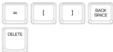
Oltre ai tasti 3Dconnexion, Numpad Pro fornisce cinque tasti globali programmabili, la cui funzione rimane la stessa a livello di sistema (indipendentemente dall'applicazione in cui si sta lavorando). Possono essere facilmente personalizzati attraverso il driver 3Dconnexion: apri il pannello **3Dconnexion Settings**, seleziona **Numpad Pro**, e fai clic su **Advanced Settings**.
